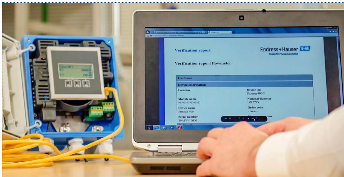
Fot. 2. Wysokie pokrycie diagnostyczne Heartbeat Technology pozwala na znaczne ograniczenie liczby tradycyjnych sprawdzeń i kalibracji przepływomierzy
